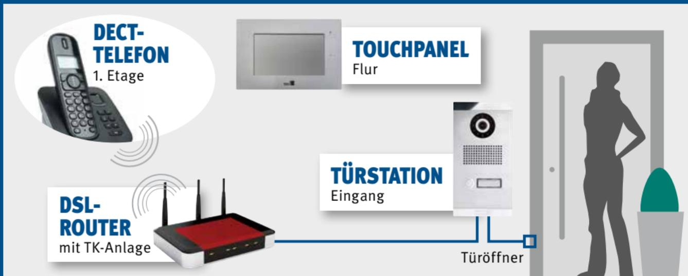
Die neuen IP-Türstationen sind mit IP-Kamera ausgestattet und zeigen dem Nutzer bei Rufauslösung die Situation vor der Tür. Die SIP-App „TC-Behnke“ ermöglicht die Übertragung von Livebild und Anruf von der Türstation zu Smartphone oder Touchpanel.
